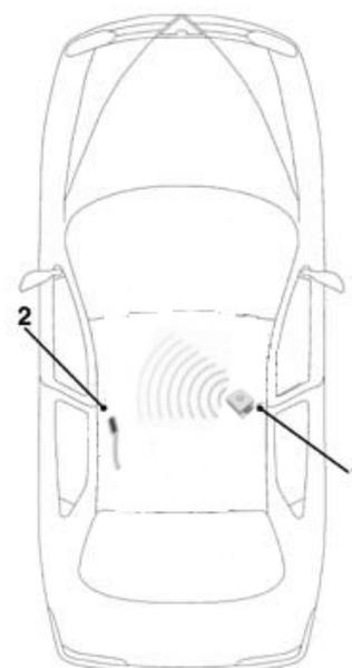
Il sistema di allarme è impostato per non scattare alla prima rilevazione da parte del sensore di movimento ma solo dopo almeno 3 eventi ripetuti a distanza di almeno un minuto l'uno dall'altro. Ciò al fine di evitare l'attivazione immediata dell'allarme per piccoli movimenti insignificanti che dovessero verificarsi all'interno del veicolo.
